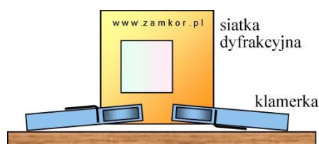
Rys. 2. Wsporniki do siatki dyfrakcyjnej
