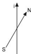
Rys. 2. Obserwowane wychylenie igielki magnetycznej z pozycji a), gdy w przewodniku zacznie płynąć prąd o natężeniu i w kierunku, jak wskazuje strzałka
