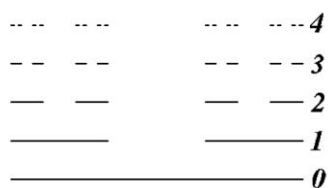
Rys. 2. Cztery kroki procesu tworzenia zbioru Cantora, polegające na usunięciu z każdego odcinka jego środkowej, trzeciej części. Kontynuując ten proces, otrzymamy zbiór fraktalny o wymiarze D = \ln 2 / \ln 3 \approx 0,63093
