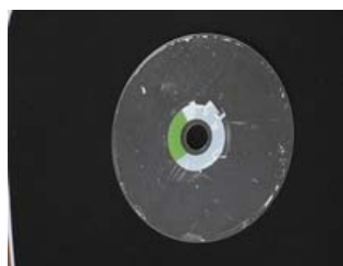
Płyta pozbawiona warstwy farby
