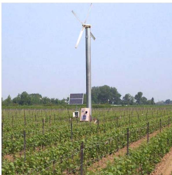
Fot. 2. Śmigło do mechanicznego mieszania powietrza. Źródło: http://www.vintegrow.com/images/windmill_pic_1_lg.jpg
