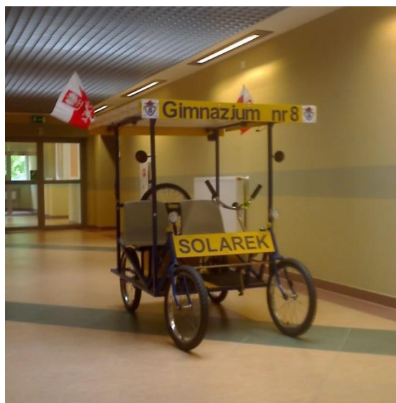
Pojazd rowerowy napędzany energią słoneczną zbudowany przez uczniów Gimnazjum nr 8 w Łodzi pod kierunkiem mgra Andrzeja Rychtelskiego (fot. S. Bednarek)
