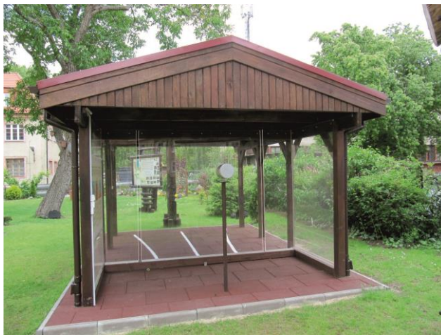
Fot. 3. Zdjęcie układu dla doświadczenia Younga w wersji akustycznej. Z przodu na słupku jest głośnik, dalej płyty z pleksi – środkowa o szerokości 200 cm i boczne odsunięte od niej o około 4 cm – tworzą pionowe szczeliny. Za płytami, na posadzce z płytek są namalowane trzy linie: jedna prosta wychodząca ze środka między szczelinami i dwie symetryczne krzywe (hiperbole) (więcej – patrz Neutrino 126)
