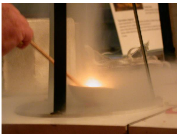
Fot. 2. Demonstracja skroplenia tlenu na ściankach stożkowatego naczynia, widocznego na górnym zdjęciu, wypełnionego parującym azotem. W obecności tlenu żarzące się drewnisko zaczyna płonąć
