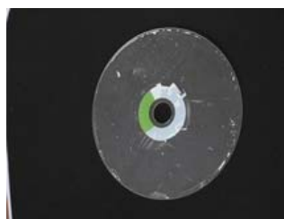
Płyta pozbawiona warstwy farby
