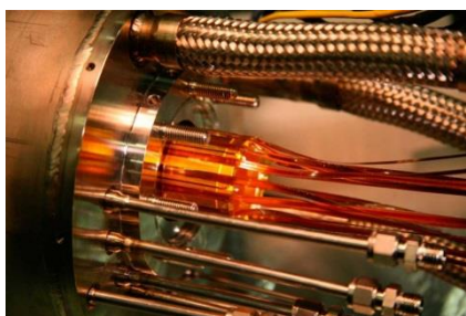
Rys. 4. Elektrody (złote) do pułapkowania ALPHA wprowadzone do komory próżniowej układu kriostatu. Jest to pułapka używana do połączenia pozytonów i antyprotonów w celu utworzenia antywodoru
