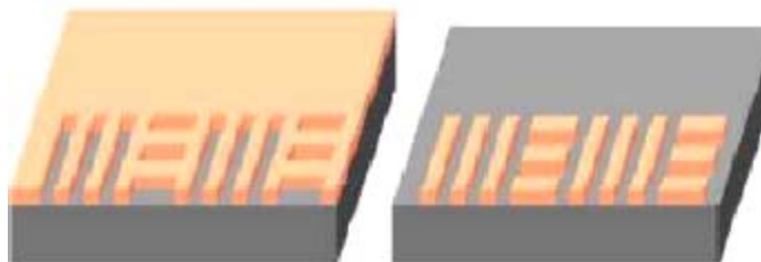
Rys. 2. Przykładowe nanostruktury powstałe przez fotolitografię [2]
