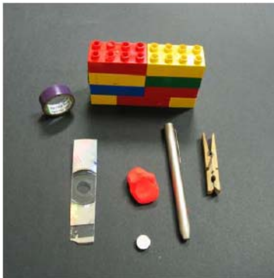
Rys. 2a. Podstawowe materiały do budowy modelu AFM (od lewego górnego rogu do prawego dolnego): taśma samoprzylepna (najlepiej izolacyjna – przyp. tłum.), klocki Lego, pasek wycięty ze środkowej części płyty CD, kawałek plasteliny, silny magnes, wskaźnik laserowy, spinacz do bielizny
