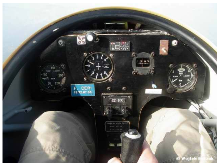
Instrumenty w kabine szybowca „ASK-18”: prędkościomierz po lewej wskazuje 85 km/h, wysokościomierz po prawej 900 m n.p.m., a wariometr pośrodku noszenie +1 m/s
