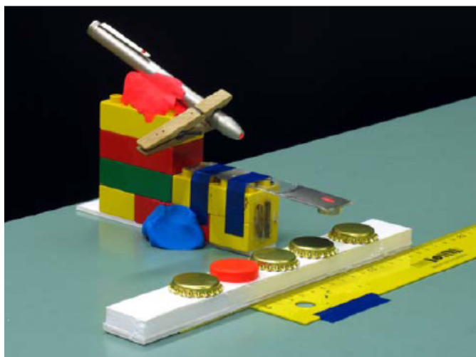
Rys. 2b. Gotowy model AFM z klocków Lego podczas pomiarów
