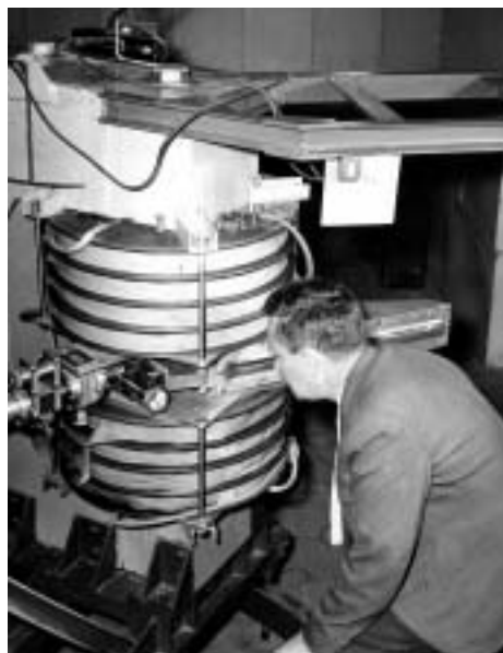
Fot. 4. Adam Strzałkowski przy spektrometrze magnetycznym, jednym z pierwszych urządzeń pomiarowych zbudowanych dla eksperymentów na krakowskim cyklotronie
