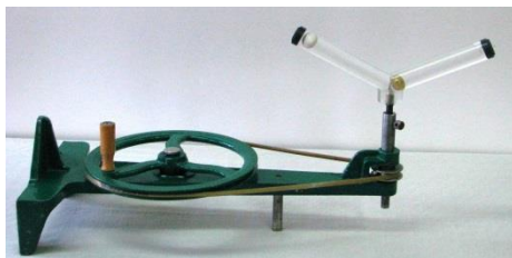
Rys. 1. V-rurka zamontowana na wirownicy
