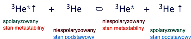
Rys. 3. Zderzenia z przekazem polaryzacji na atomy ^3\text{He} będące w stanie podstawowym
