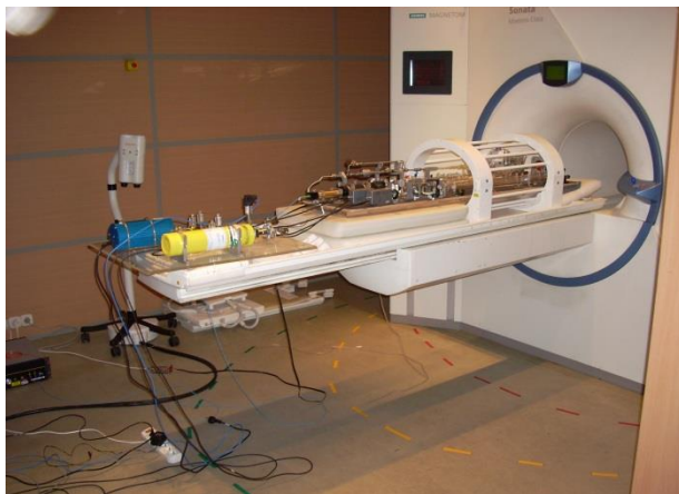
Rys. 4. Polaryzator ^3\text{He} zaprojektowany do pracy w środku medycznego skanera (fot. Bartosz Głowacz)
