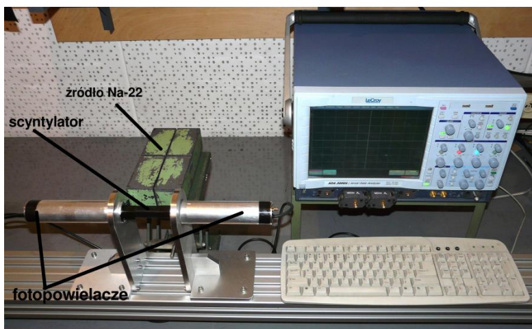
Rys. 3. Układ pomiarowy, po lewej stronie w aluminiowych obudowach umieszczone są dwa fotopowielacze, a pomiędzy nimi jest scyntylator owinięty czarną taśmą zabezpieczającą przed zewnętrznym światłem. Za tym układem ustawiony został kolimator ołowiany ze źródłem promieniotwórczym kierujący wiązkę promieniowania w konkretny obszar scyntylatora. Po prawej stronie znajduje się oscyloskop
