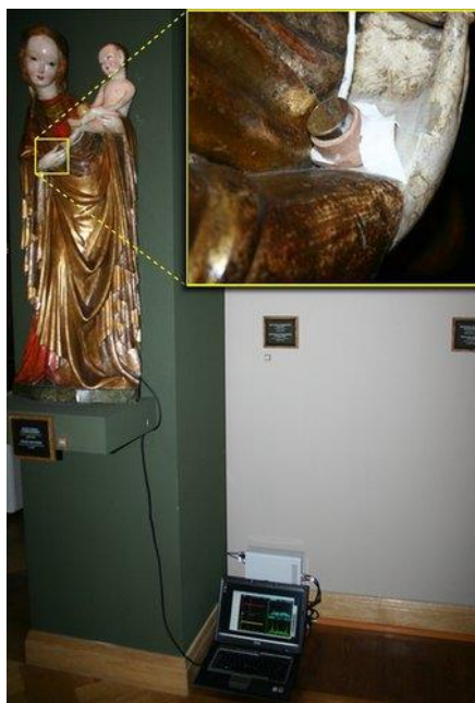
Średniowieczna rzeźba Madonny z Kruźlowej wraz z systemem monitorowania. Zbliżenie czujnika AE przymocowanego do wnętrza dłoni
