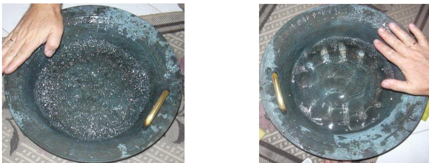
Rys. 4. Podobną falę stojącą można wytworzyć w misce z wodą (tu specjalna miska z brązu ze zbiorów dydaktycznych www.teachersource ). W zależności od sposobu wzbudzenia obserwuje się cztery „rogi” fontanny lub sześć
