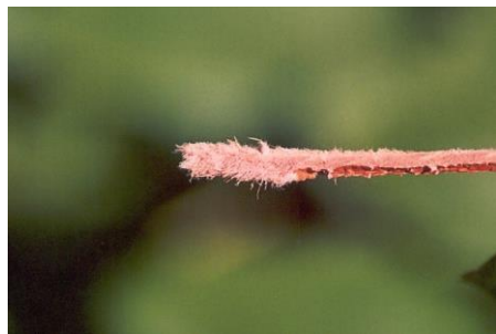
Rys. 5. Koniec rzemiennego bicza postrzępiony po kilkunastu strzałach
