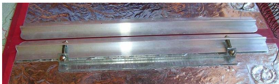
Fotografia pokazuje jak można wykonać regulowane elektrody
