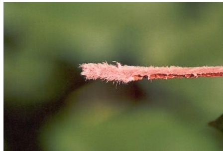
Rys. 5. Koniec rzemiennego bicza postrzępiony po kilkunastu strzałach
