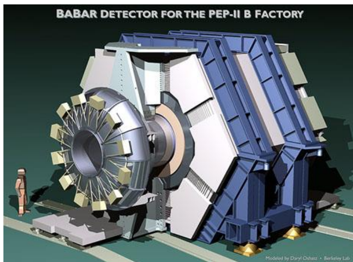
Rys. 11. Widok detektora BaBar. W zderzeniach elektronów z pozytonami wewnątrz detektora powstają między innymi mezony o nazwie \Upsilon(4S) , które następnie rozpadają się na kwantowo splątane pary mezonów B. Detektor pozwala na rejestrowanie cząstek z rozpadów mezonów B. Obrazek pochodzi ze strony internetowej: http://www.slac.stanford.edu/BFROOT/www/Detector/Images/Images.html
